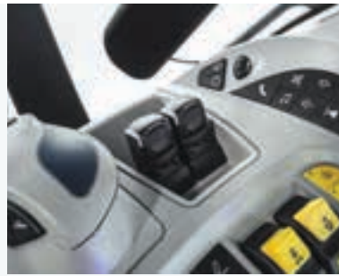
Optioneel paneel voor afstandsbediening hydraulica met 2 hendels
